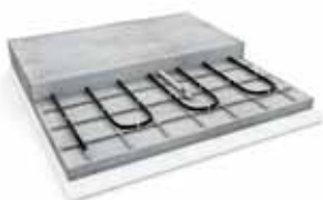
Montaż kabla Tash w betonie
